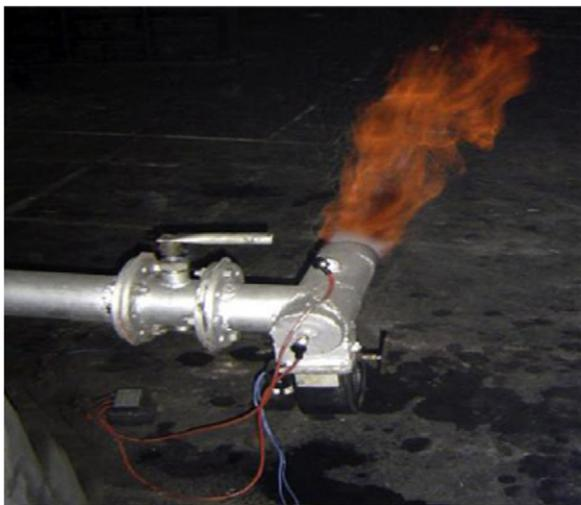
Fig. 13. Produce gas burner.
